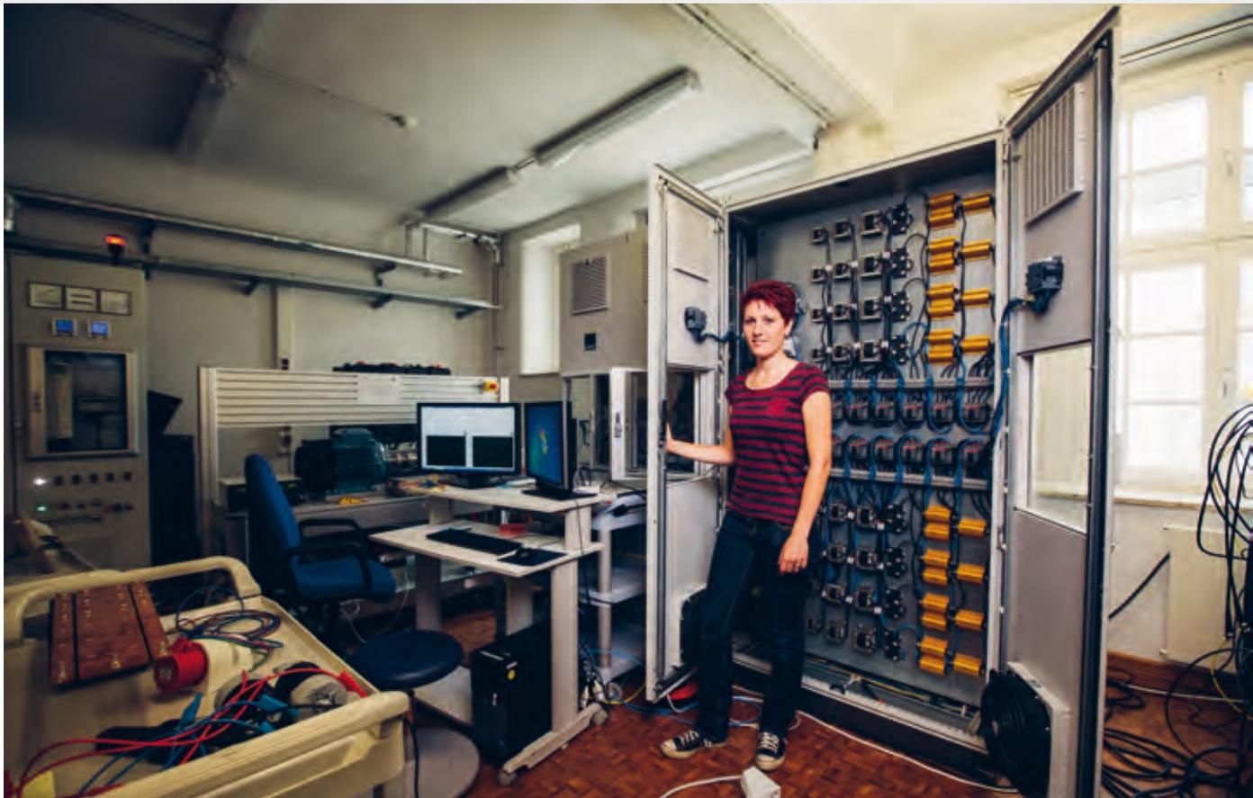
ders erfolgreiche Innovation der Wissenschaftler ist die virtuelle Synchronmaschine VISMA, die die Aufgabe tonnenschwerer Turbinen eines konventionellen Kraftwerks übernehmen und die Residuallast eines Netzes regeln kann. Für die neue Technologie, aus der in Zukunft auch regenerative Speicherkraftwerke entstehen sollen, ist ein weltweites Patent erteilt worden.
